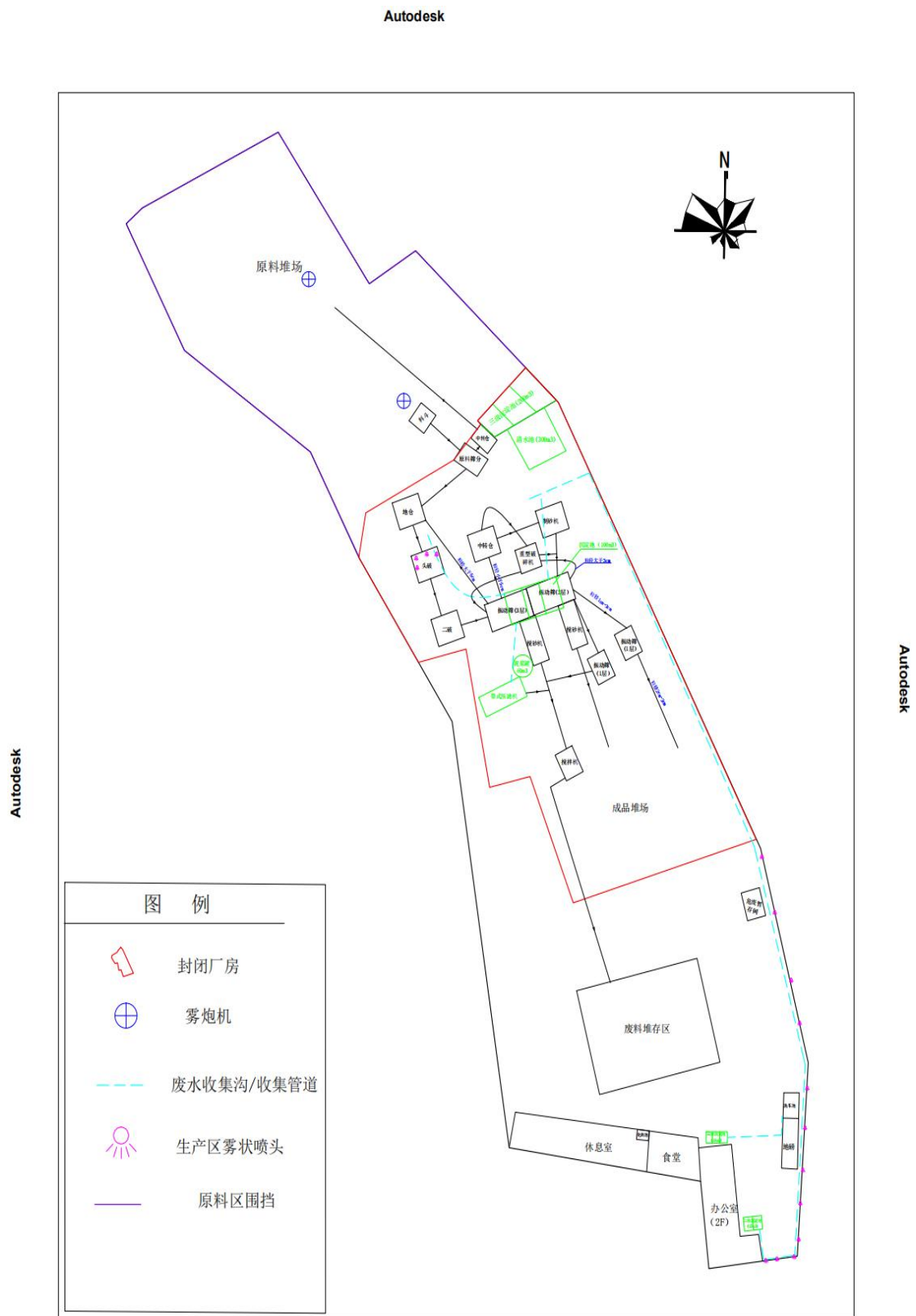
附图2 项目平面布置和环保设施布置图
