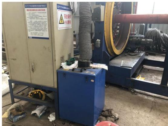
图 4-1 焊接烟气净化器
